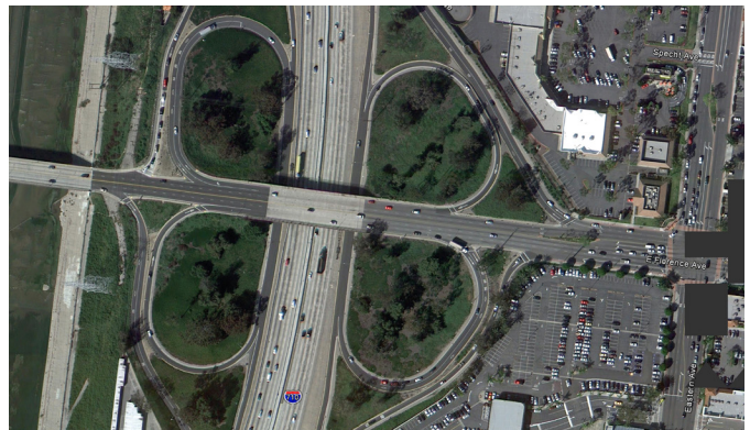
Los intercambios viales de tipo "trébol" construidos en los años 50 no tienen la capacidad para manejar el volumen de tráfico actual.
